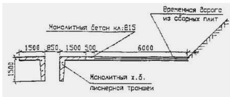
Рис. 7.4. Сопряжение воротника форшахты с временной дорогой
