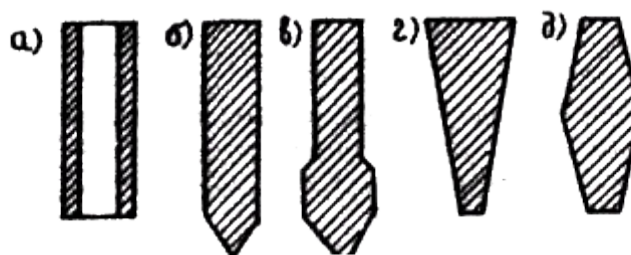
Рис.13. Продольный профиль железобетонных свай:
